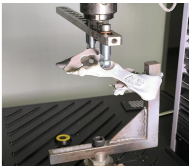
Rys.1. Stanowisko pomiarowe dla modelu miednica-implant
